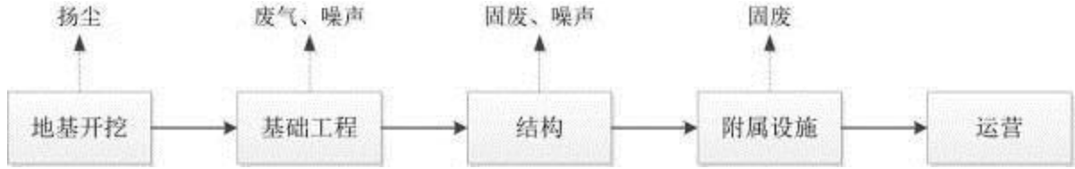
图 6 施工工艺流程及排污节点图
